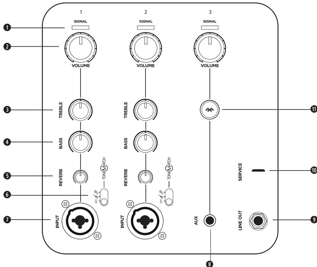
Mikrofone und Musikinstrumente lassen sich an die Eingänge an Kanal 1 und 2 anschließen. Die integrierte ToneMatch® Signalverarbeitung verleiht Mikrofonen und Instrumenten einen optimalen Klang. Kanal 3 ist für Bluetooth®-Verbindungen und Line-Pegel-Eingänge vorgesehen.
