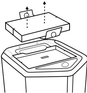
4. Setzen Sie den neuen Akku ein und stellen Sie dabei sicher, dass die Anschlussstifte in der richtigen Position sind.
