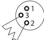
Die Verwendung eines Abschlusswiderstands (Terminierung) reduziert Interferenzen und andere Probleme bei der Signalübertragung. Es ist immer ratsam, ein DMX-Abschlussmodul (Widerstand 120 Ohm, 1/4 W) zwischen Pol 2 (DMX-) und Pol 3 (DMX+) des letzten Geräts in der Kette einzufügen.
