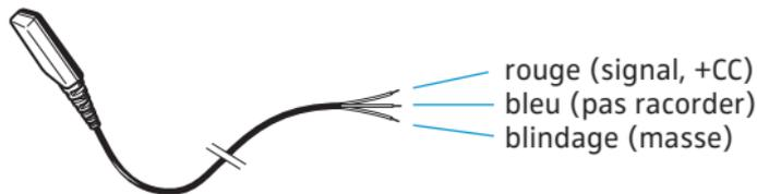
Câblage des fils pour l'adaption à un jack 3,5 mm ou à un connecteur spécial.
