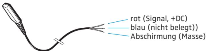
Kabelbelegung für Adaption an 3,5-mm-Klinke oder Spezialstecker
