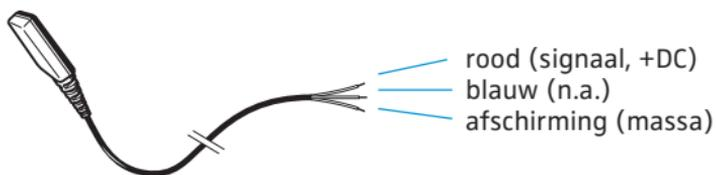
Kabelbezetting voor aansluiting op 3,5 mm jack plug of speciale stekker.
