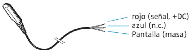
Asignación de cables para la adaptación al conjuntor de 3,5 mm o conector especial.
