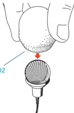
Otra reducción de los ruidos del aliento y del viento en 10 dB la consigue con el componente en red de espuma MZW 02.
