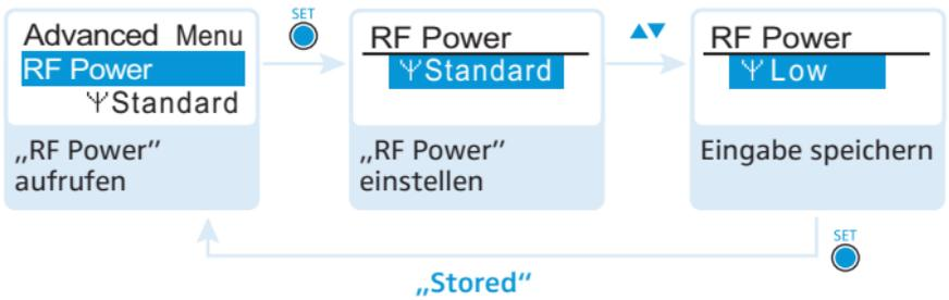
Im Menüpunkt „RF Power“ können Sie die Sendeleistung in 2 Stufen einstellen.
