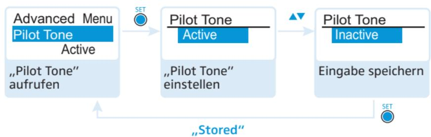
Der Pilotton hat eine nicht hörbare Frequenz, die vom Taschensender übertragen und vom Empfänger ausgewertet wird.
