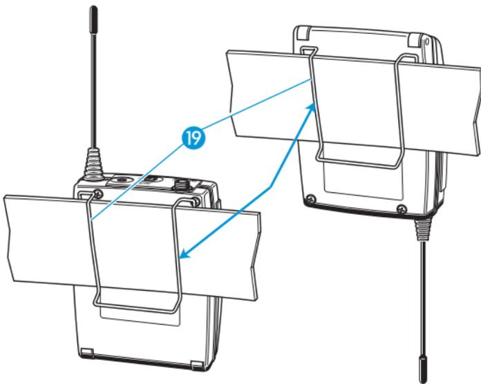
Sie können den Taschensender auch so an der Kleidung befestigen, dass die Antenne nach unten zeigt. Nehmen Sie dazu den Gürtelclip 19 heraus und setzen Sie ihn um 180° gedreht wieder ein.
