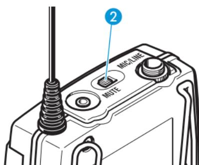
Mit dem Stummschalter **MUTE ②** können Sie das Audiosignal stummschalten oder das Funksignal deaktivieren.
