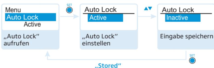
Diese Sperre verhindert, dass der Taschensender unbeabsichtigt ausgeschaltet wird oder Veränderungen vorgenommen werden. In der aktuellen Standardanzeige zeigt das Schloss ⑤ an, dass die Tastensperre eingeschaltet ist.
